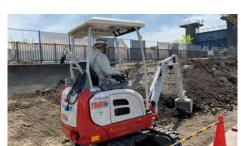
電動バックホーの採用(試験採用)
